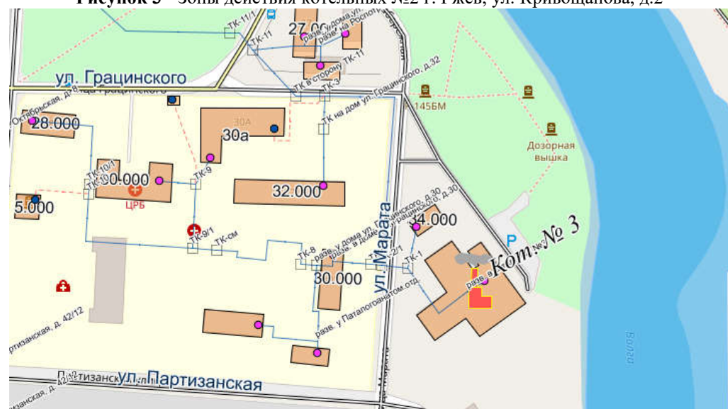
Рисунок 4 - Зоны действия котельной №3 г. Ржев, ул. Марата
